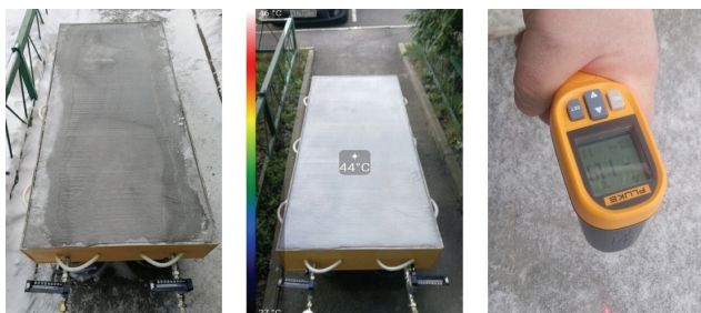
Рисунок 8. Модельная плита во время зимних экспериментов по нагреву (слева), во время летних экспериментов по охлаждению (в центре). Пирометрическое измерение температуры поверхности модели (справа). (Фотографии сделаны авторами).
